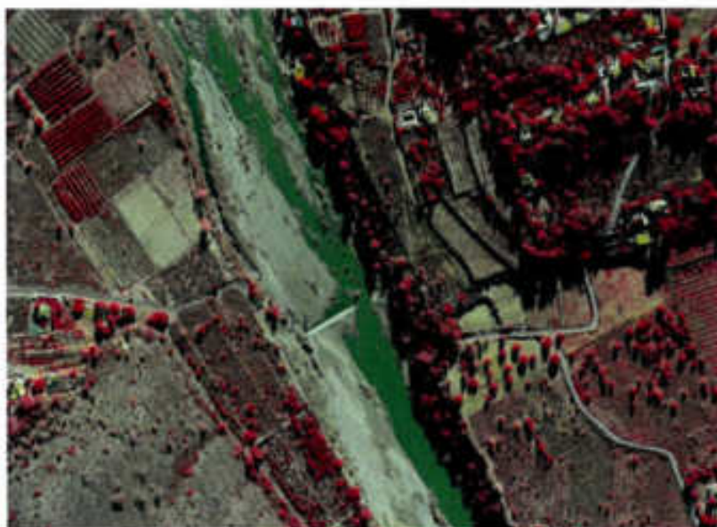
Exemplo de Imagem da zona de Valência em infravermelho próximo GSD - 30 cm
